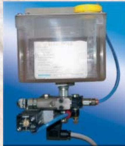
La lubrificazione è indispensabile per evitare il bloccaggio della lama sui pattini in Widia ed aumenta la durata della lama.
