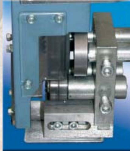
La salita e discesa del guida lama e della protezione avviene mediante una cremagliera guidata da due boccole in bronzo azionata da un motoriduttore che permette di avvicinarsi al pezzo da tagliare senza nessuno sforzo dell'operatore.
